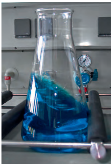
Abb. 1: Vibrationsmischen mittels Rütteltisch im Labor
