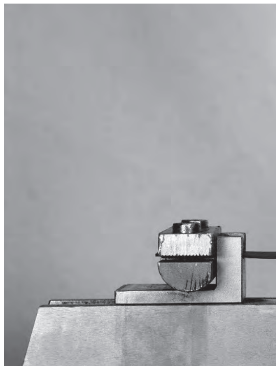
Externe Belastung für die Anwendung: Schlagzugversuch zur Prüfung von Folien
