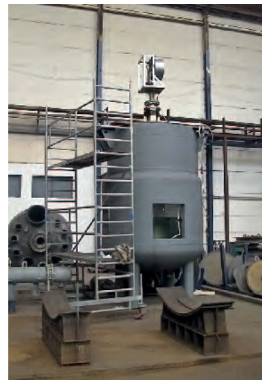
Abb. 2: Großtechnischer RST-Mischbehälter zur Durchführung grundlegender Untersuchungen zur Dispergierwirkung bei der Thaletec GmbH
