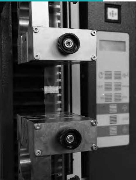
Zugprobe: Peel-Test an Folien, um das Aufreißverhalten z. B. einer Käseverpackung zu prüfen, Foto: KKZ
